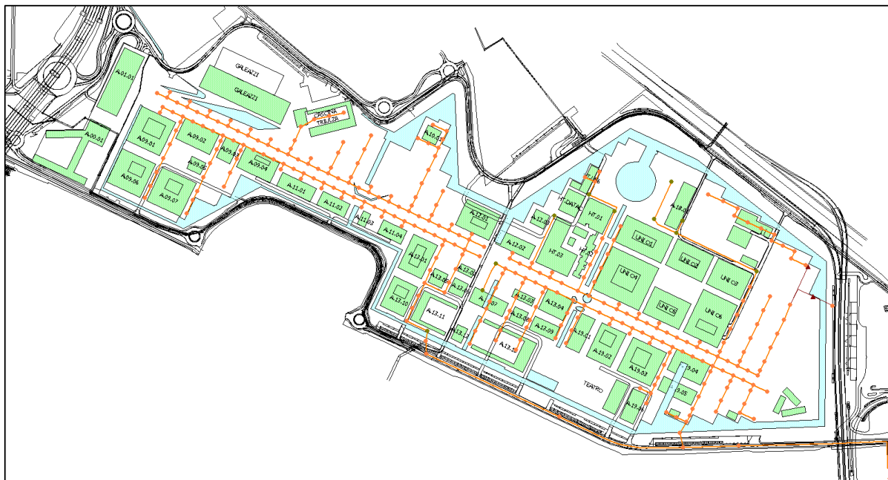
Fig. 17 Schema rete nera desunta da modello di simulazione
